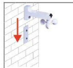
3. Utilice la tapa trasera para realizar las marcas en los puntos de sujeción de la pared.
